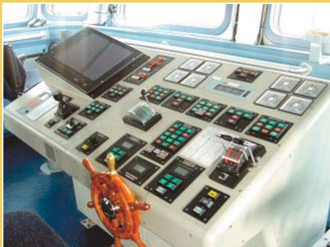
Consola de gobierno de un cazaminas tipo Segura.
