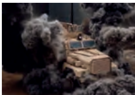
Prueba de resistencia frente a la explosión de un IED de un vehículo tipo MRAP del modelo Cougar HE del fabricante Force Protection Industries.
