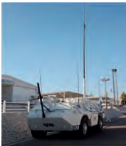
Vehículo FDC / PC avanzado de la Bía. CAESAR CAESAR, enlazado con el resto de medios por medio del sistema ATLAS y las PR4G.
