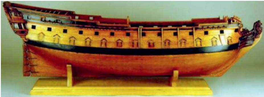
Casco del navío San Fulgencio , de 64 cañones (1787-1814), en boj y caoba. Construido en Cartagena con planos de José Romero y Fernández de Landa (1737-1807). Museo Naval de Madrid (MNM-396)
