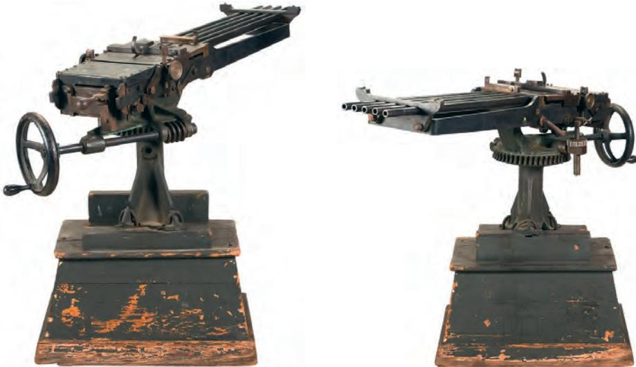
Dos vistas de una ametralladora Maxim Nordenfelt de 11 mm y cinco tubos. En la imagen falta el pedestal metálico sobre el que estaba montada, aquí sustituido por un cajón de madera. (Fotos: Archivo MdR Almirante de Castilla)
