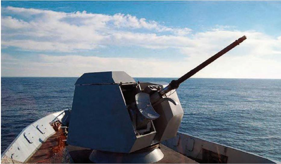
Montaje Oto Melara de 76 mm con el sistema STRALES. Nótese la pequeña antena para guiar la munición. (Fuente: Leonardo)
